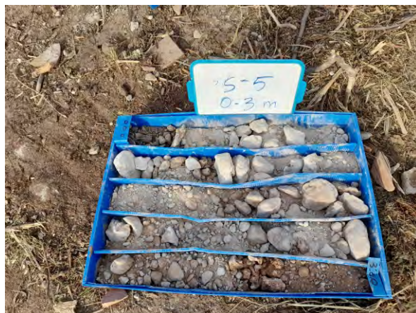
Foto 41. Sondeig S-5, de 0 a 3 metres de profunditat
