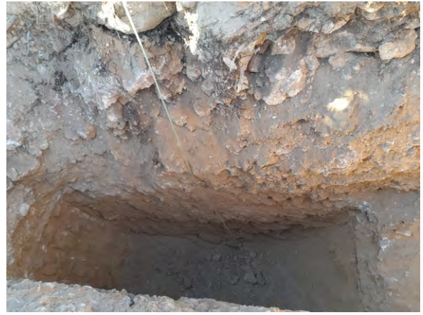
Foto 2. Calicata C-1, de 0 a 3,5 metres de profunditat
