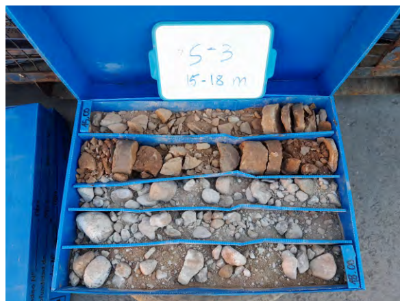
Foto 35. Sondeig S-3, de 15 a 18 metres de profunditat
