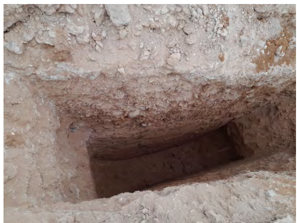
Foto 16. Calicata C-8, de 0 a 4 metres de profunditat
