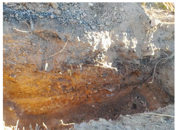
Foto 6. Calicata C-3, de 0 a 3 metres de profunditat
