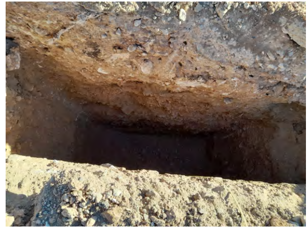
Foto 4. Calicata C-2, de 0 a 3,5 metres de profunditat
