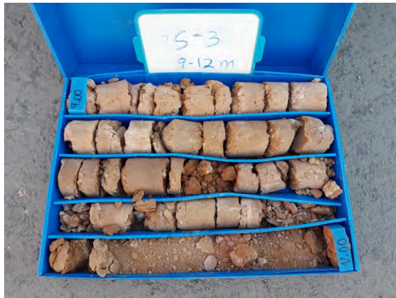
Foto 33. Sondeig S-3, de 9 a 12 metres de profunditat
