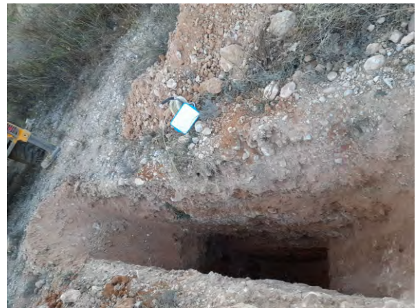
Foto 22. Calicata C-11, de 0 a 4 metres de profunditat
