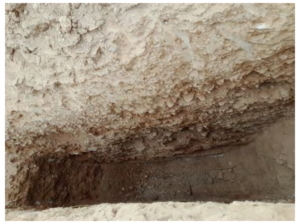
Foto 14. Calicata C-7, de 0 a 3 metres de profunditat
