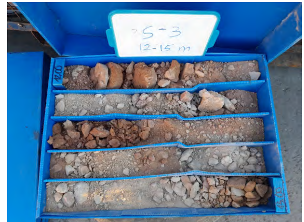
Foto 34. Sondeig S-3, de 12 a 15 metres de profunditat
