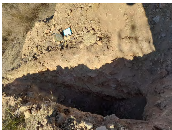
Foto 18. Calicata C-9, de 0 a 3 metres de profunditat
