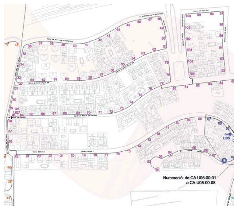
Fragment del plànol del projecte d'enllumenat amb indicació dels punts de llum a Casalot/ Zona Roma.
