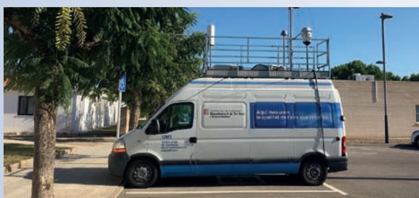
La unitat atmosfèrica transmet dades cada 10 minuts per analitzar diversos ítems
