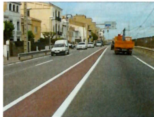
Exemple en què s'ha establert una mitjana pintada, estrenyent els carrils de circulació.
