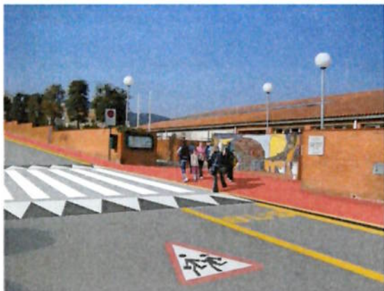
Figura 70. Fotomuntatge proposta de plataforma sobreelevada que cobreixi tot l'entorn d'accés a l'escola i que inclogui parada de transport col·lectiu i diferents elements de mobiliari urbà
